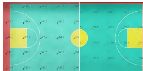
Gambar 33. Intensitas cahaya lapangan pada kondisi desain pagi hari
