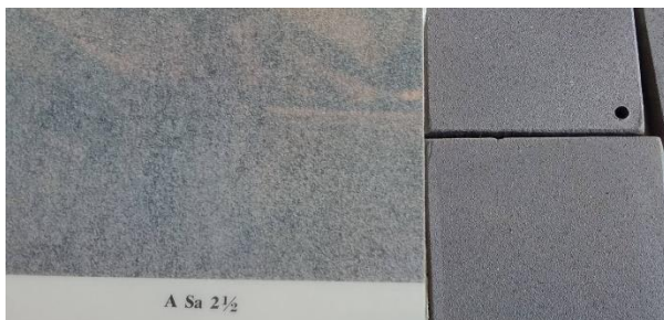
Gambar 2 Tingkat Kebersihan Spesimen Hasil Blasting
